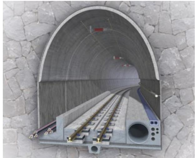
À gauche, la ligne à haute tension séparée du train par un mur massif.
