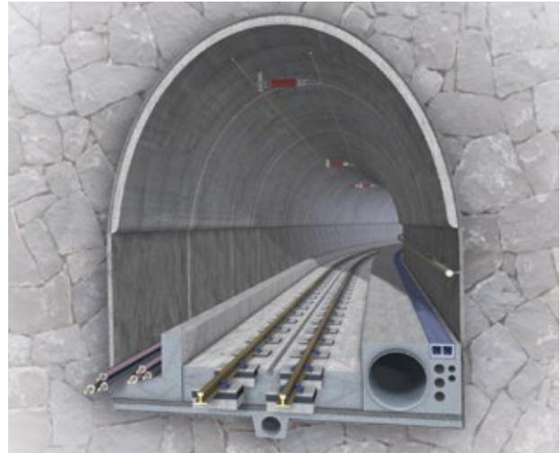
Abb. 4: Mögliches Konzept für die Parallelführung: Kabel in gebündelter Verlegung, Leitmauer, Gleis, Fluchtweg und Lüftungsrohr für Personen-Schutzräume (von links nach rechts).
