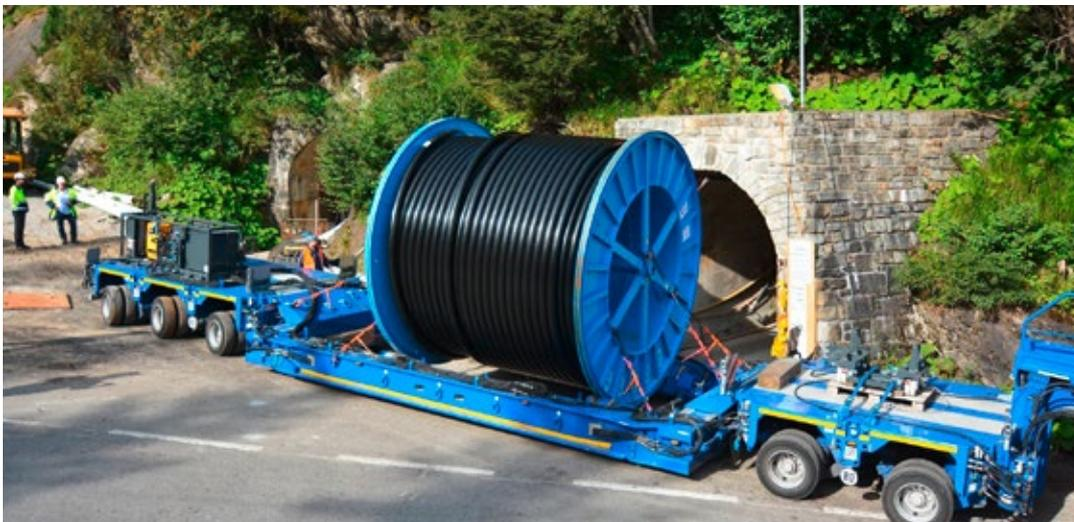
Abb. 3: Der Kabeltransport ist eine Herausforderung. Im Bild ein 1,2 km langes Kabel mit einem Gewicht von über 40 Tonnen.
