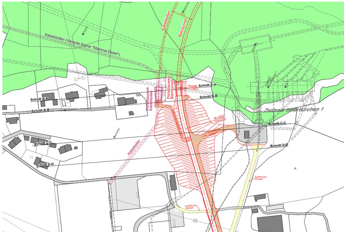
Abbildung 26: Portal Innertkirchen mit Leitungskanal zur Schaltanlage. Konzept-Vorschlag für eine gemeinsame Führung der Kabelleitungen des Grimseltunnels mit den verkabelten Leitungseinführungen von Norden her.
